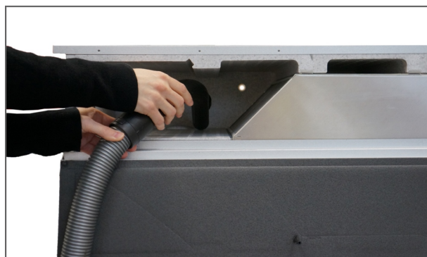
4. Det er en god idé at støvsuge filterkammerene for evt. snavs, der kan forekomme
